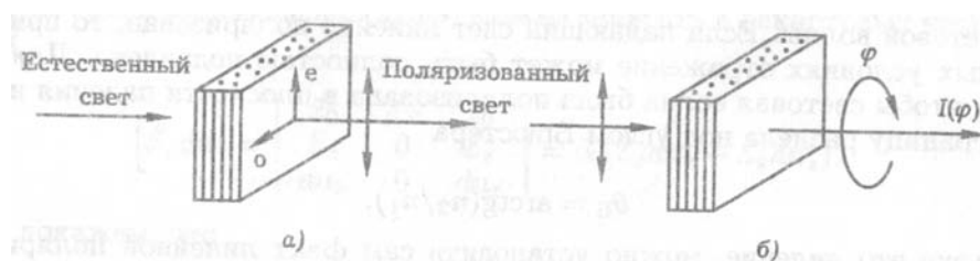
Рис. 13.4. Анизотропное поглощение. Получение (а) и анализ света с помощью кристалла турмалина
